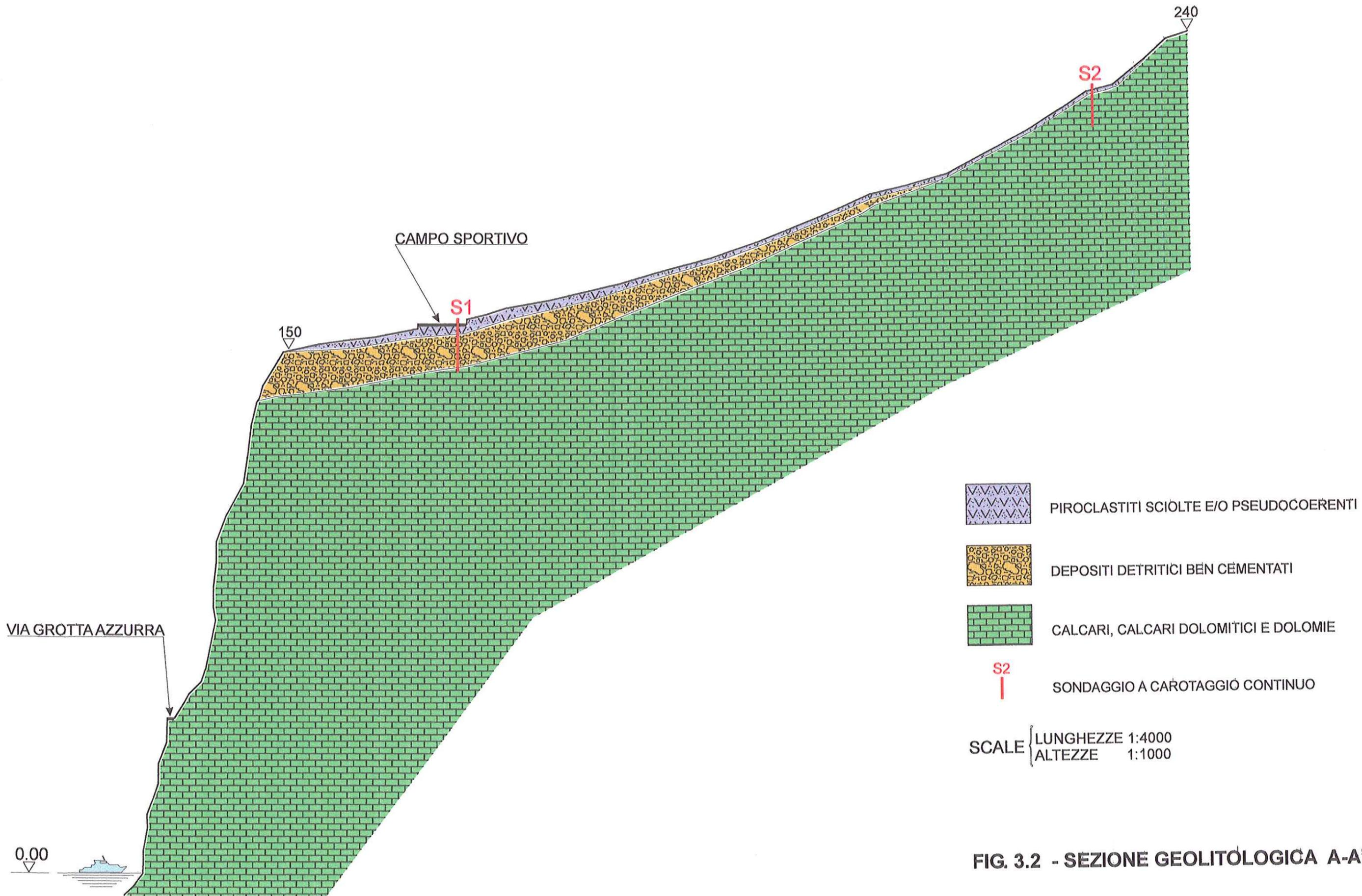
FIG. 3.2 - SEZIONE GEOLITOLOGICA A-A'
