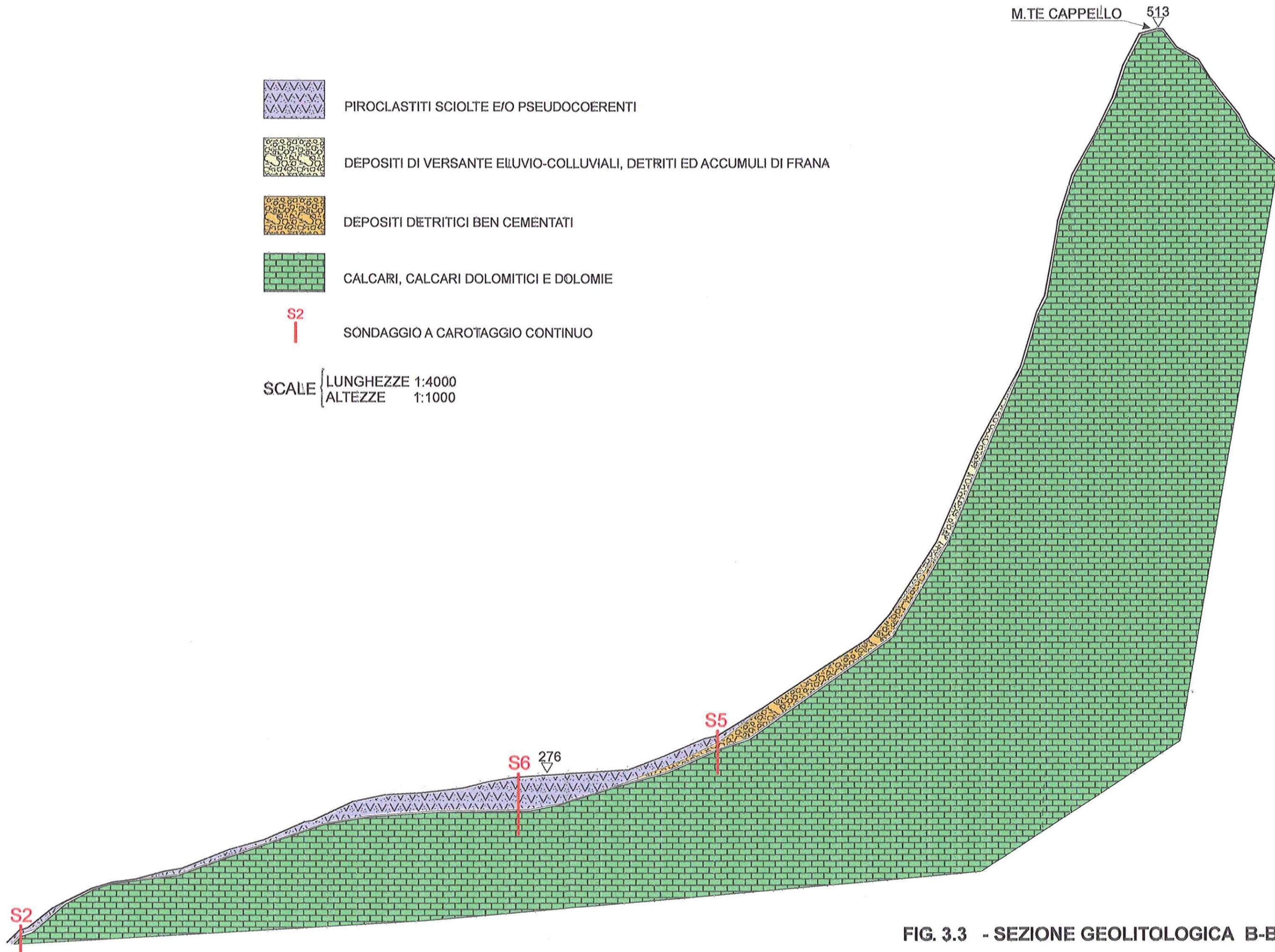
FIG. 3.3 - SEZIONE GEOLITOLOGICA B-B'
